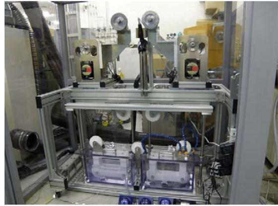
図 2.4.3-52 Reel to Reel エッチング
