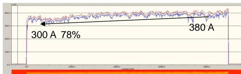
図 2.4.3-27 チューブ塗布方式により作製した線材の  $I_c$  特性分布
