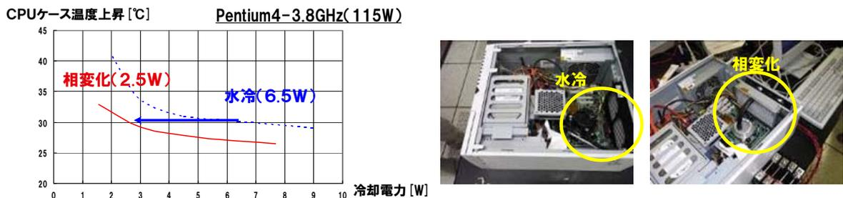
柔軟接続チューブ構造開発では、集熱沸騰冷却システムの長期の連続運転試験を実施（継続中）し、冷媒の抜けやチューブ材との反応による温度上昇を生じずに、安定した冷却性能が得られることを確認した。接触伝熱構造開発では、従来のグリースと比較し40%の熱抵抗を低減するサーマルパッドを開発し、5年分の加速条件下でのパワーサイクル試験後でも性能に問題ないことを確認した。
