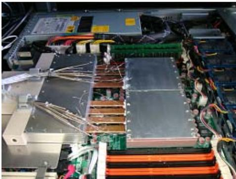
図 4-6 ヒートパイプによる CPU 冷却
