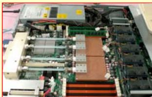
・CPU直接設置の高性能ヒートスプレッダ。
