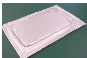
多孔質セラミックス粒子・ポリマー封止サンプル試作。
