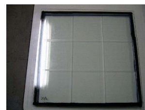
シリカエアロゲル(透明体)・ガラス封止サンプル試作。
