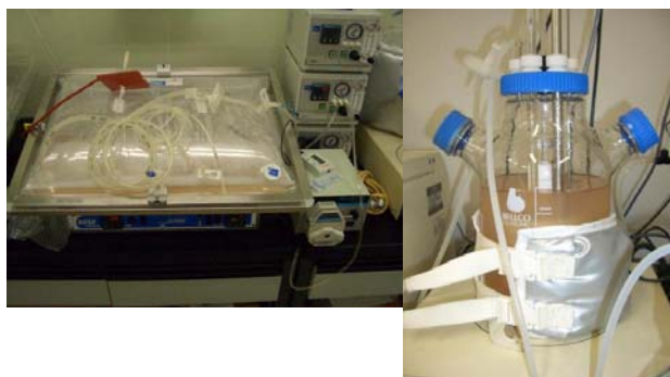
図1 バイオリアクターを用いたヒト培養細胞による大量発現系異なる機構のバイオリアクター2種を用い、発現系を構築した。左:WAVEバイオリアクター 右:セルマスター
