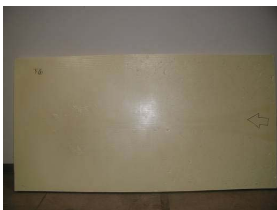
図 3.2.1.3.2.6 PUF パネル 900 \times 1800 \times 50mm
