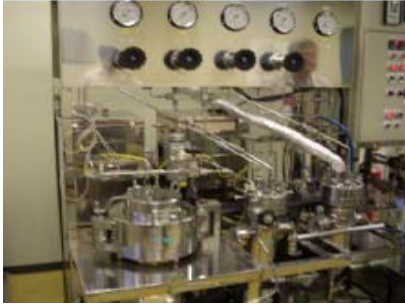
写真 1 超臨界抽出設備
