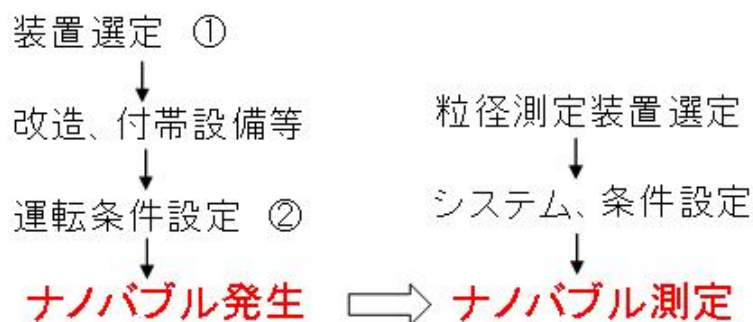
図 3.2.1.3.1.1 ナノバブル発生、測定までの流れ
