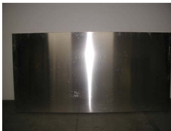
図 3.2.1.3.2.7 金属面材 PUF パネル 900 \times 1800 \times 50mm
