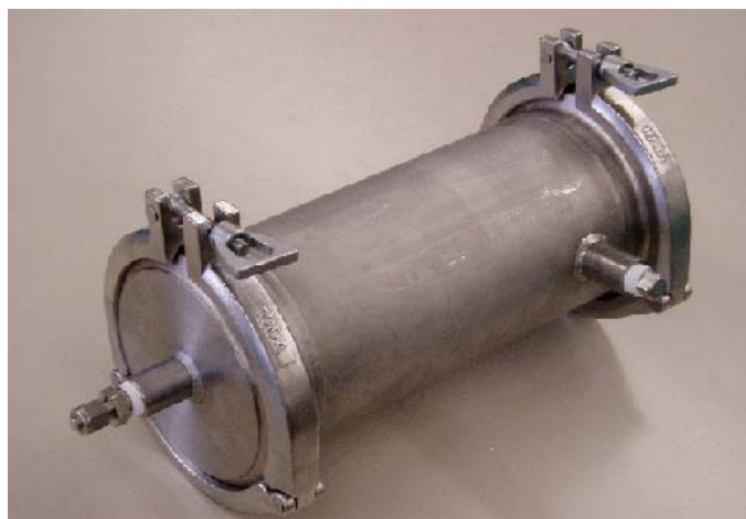
図 A-(6)-14 SPP0 炭素脱水膜のプロトタイプモジュール（膜面積 0.4m 2 ）
