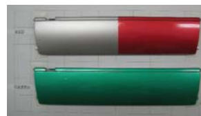
図 B-(5)-20 下塗/トップ UV カラークリア塗料（レッド・グリーン）
