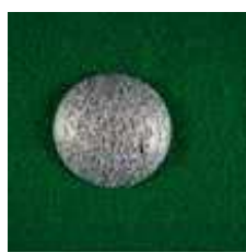
化成処理品（腐食発生）
