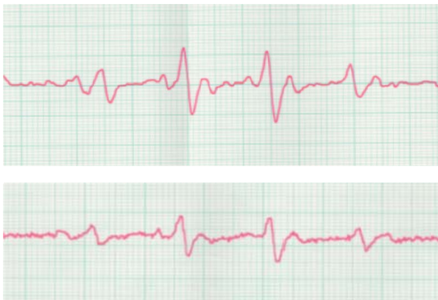
図 A-(4)-5 (上) 蒸留水 3 L に 10 分間、酸素マイクロバブル (低濃度型) を流通・圧壊させて生成するラジカル、(下) 10 秒間オゾンマイクロバブル流通圧壊の場合、(1:2:2:1 のピーク OH に帰属できる)
