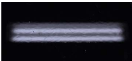
図 B-(5)-8 ユズ肌が現れている塗膜の外観
