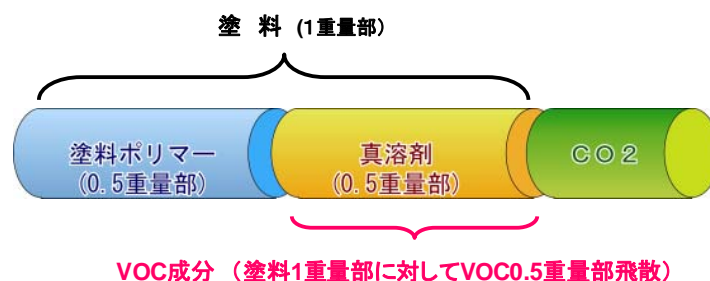
図 B-(5)-5 有機溶剤系スプレー塗装と二酸化炭素スプレー塗装の VOC 排出量の比較
