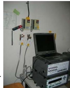
トレーサーガスとフード付き風量計を用いた換気システムの風量のクロスチェック
