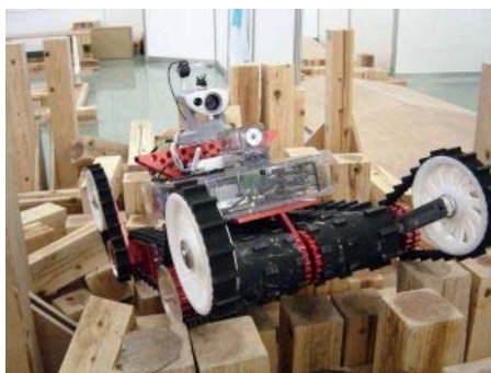
図6 被災建造物内移動RTシステム
