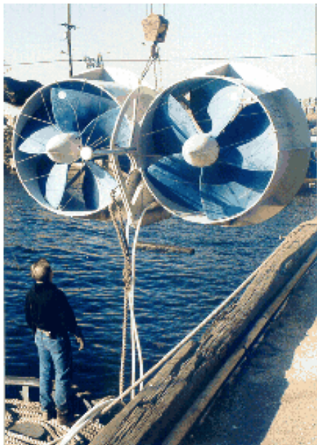
図 8 アンダーウォーター・エレクトリック・カイト社 の 水中タービン
