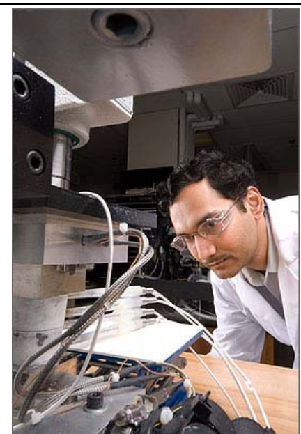
NREL の Sreekant Narumanchi 上級エンジニアは、ハイブリッド車のマイクロエレクトロニクスに使用される熱移動ゲルに関する温度と圧力試験の経過を見ている。
