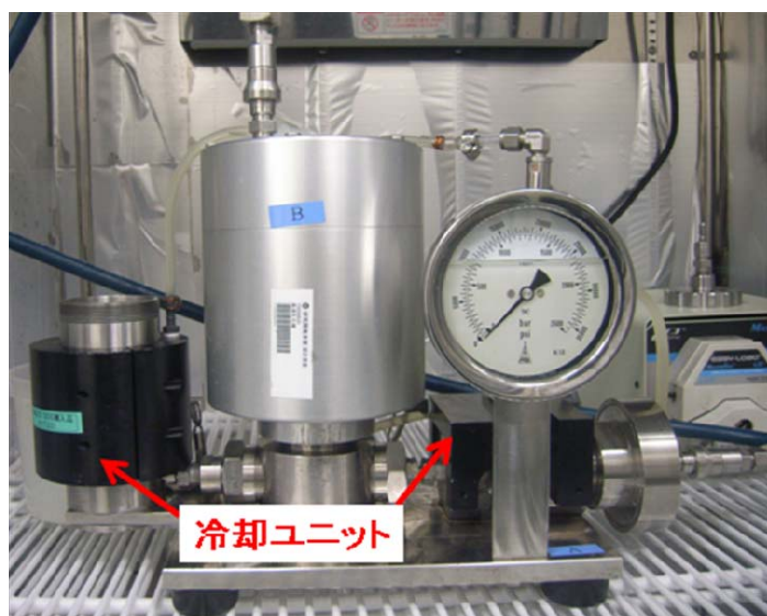
図 2)-1-1-13 高圧乳化処理装置用冷却ユニット
