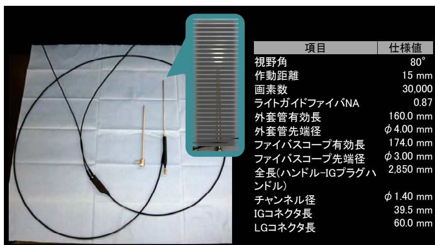
図 1-27. 大型動物用膀胱用内視鏡システムの外観と諸元
