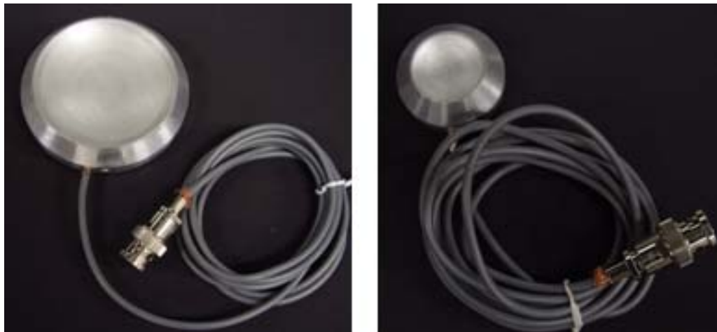
図 2)-2-2-2 開発した単素子球面トランスデューサの例 (左 : 0.8MHz 右 : 8MHz)
