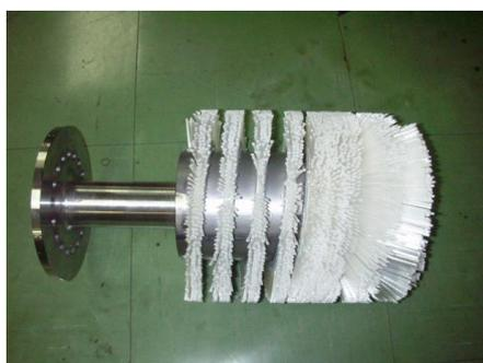
写真 3-6 仕上げ用剥離機
