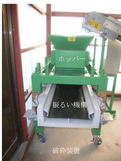
写真 4-3 破砕装置 外観
