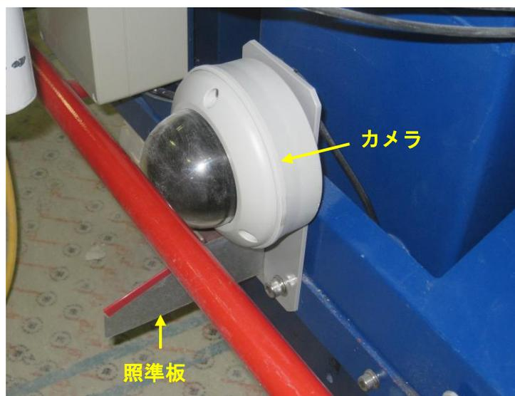
図 2.3-11 走行用監視カメラ取付け状況
