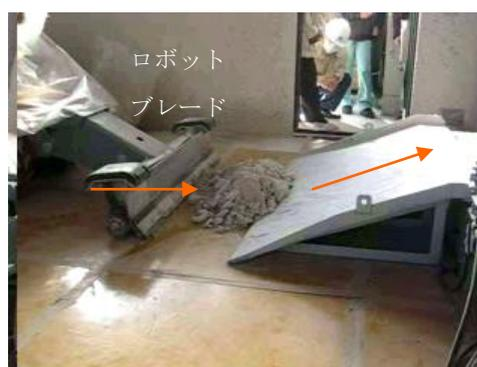
写真 4-2 移載装置 (ロボット操作時)
