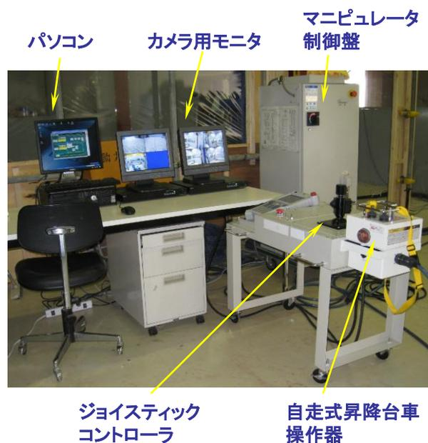
図 2.1-3 剥離ロボット操作システム
