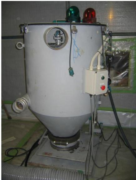
写真 7-17 回収・袋詰装置 (清掃後)
