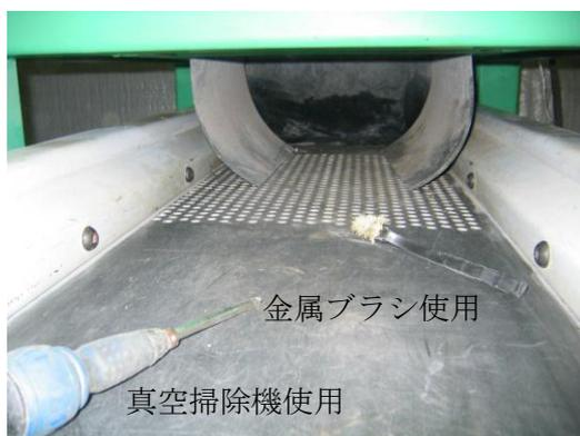
写真 7-13 破碎装置（清掃中）
