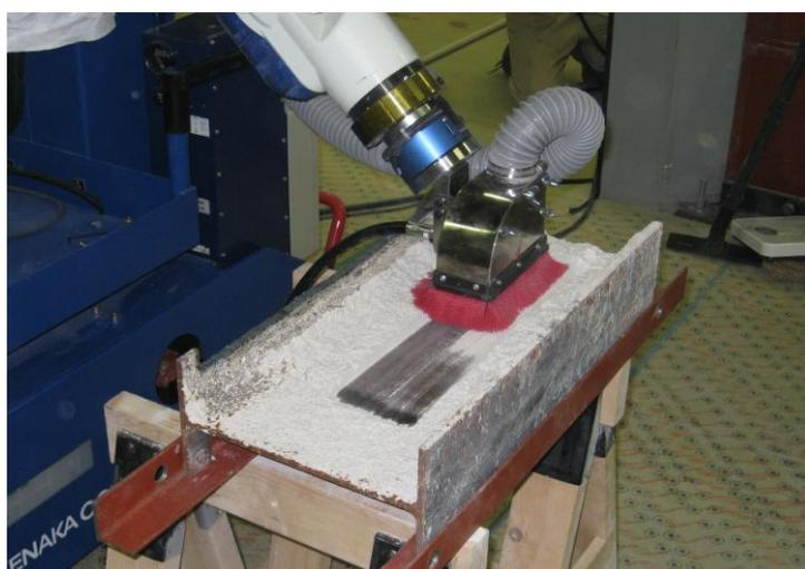
図 3.3-1 剥離装置の動作確認状況
