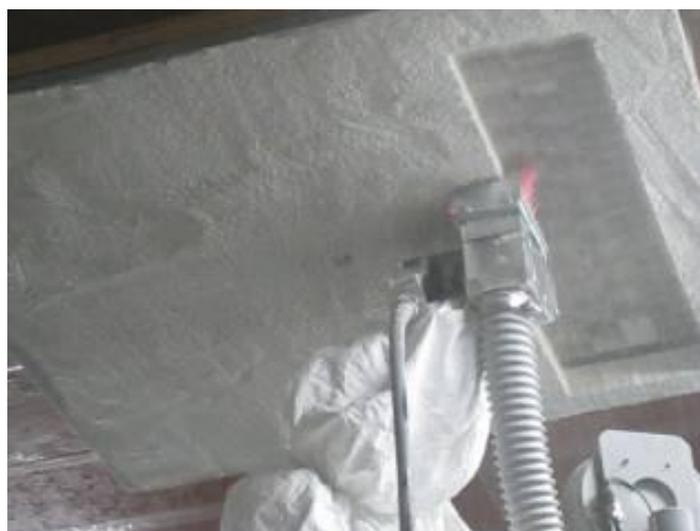
図 5.3-7 平板モックアップ剥離実験状況
