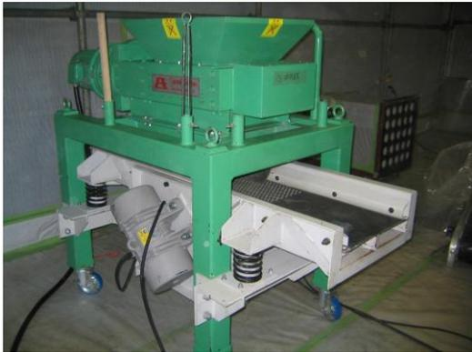
写真 7-14 破碎装置 (清掃後)
