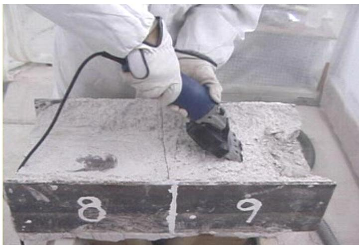
図 3.2-3 工具⑧振動剥離機
