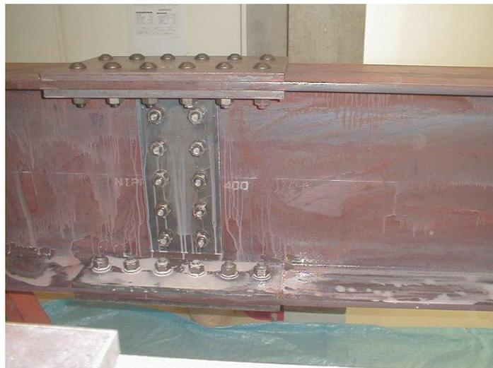
図 5.3-8 鉄骨モックアップジョイント部概要
