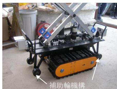
写真 5-1 無線式監視カメラ装置 外観
