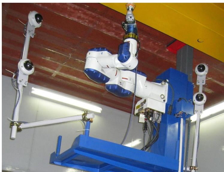
図 2.2-12 剥離作業監視カメラ取付け状況
