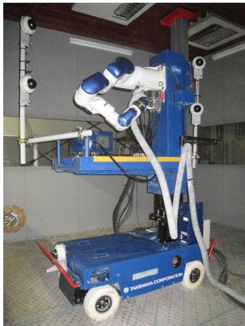
図 5.1-2 剥離ロボット全景
