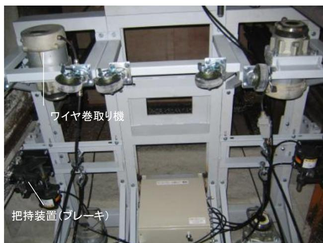
写真 3-8 昇降ゴンドラ架台装置（見上げ）
