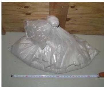
紛体状の剥離物 従来比体積1/1.9
