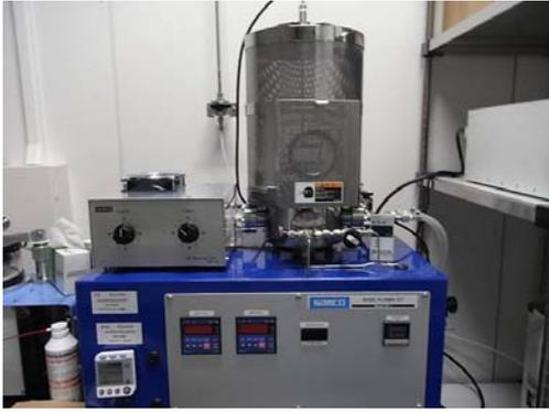
図 1.2-19 本事業で導入したプラズマエッチング装置。メソポーラス膜の表面処理に用いた。
