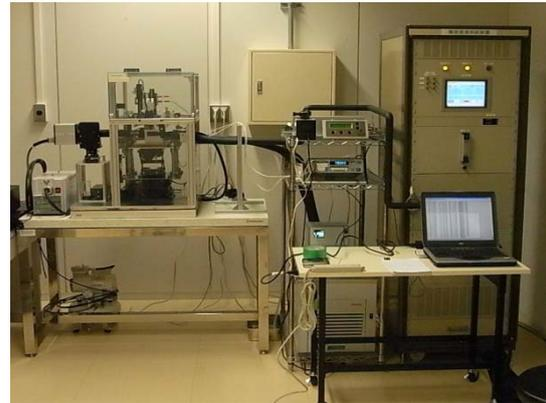
図 3.2-14 微小水滴接触角測定装置
