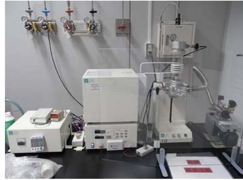
図 1.2-20 本事業で導入したマイクロ波誘導加熱炉。メソポーラス膜の高温焼成に用いた。
