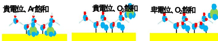
図 1.2-29 SEIRA スペクトル解析結果から想定した界面の微視的描画。青:酸素原子、赤:水素原子、緑:塩素原子
