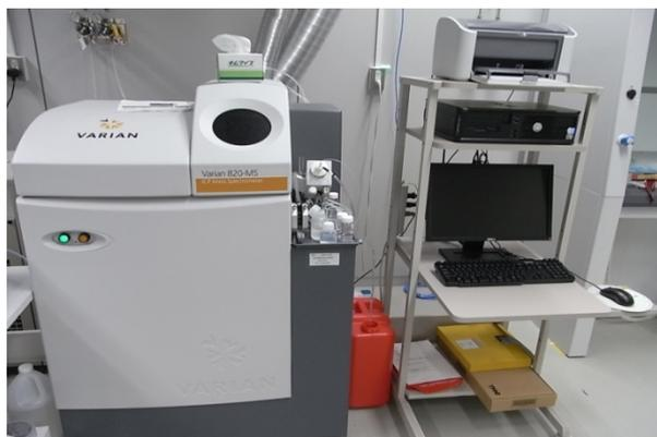
図 1.2-26 本事業で導入した ICP-MS 装置。メソポーラスモデル材料の分析に使用した。
