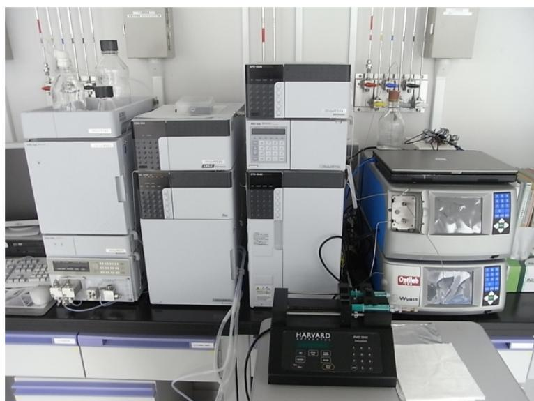
図 2.2-23 GPC-MALLS 装置 (左) 電解質材料の分子量測定
