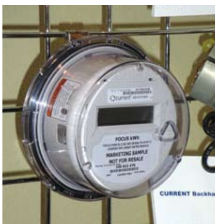
スマートメーター
