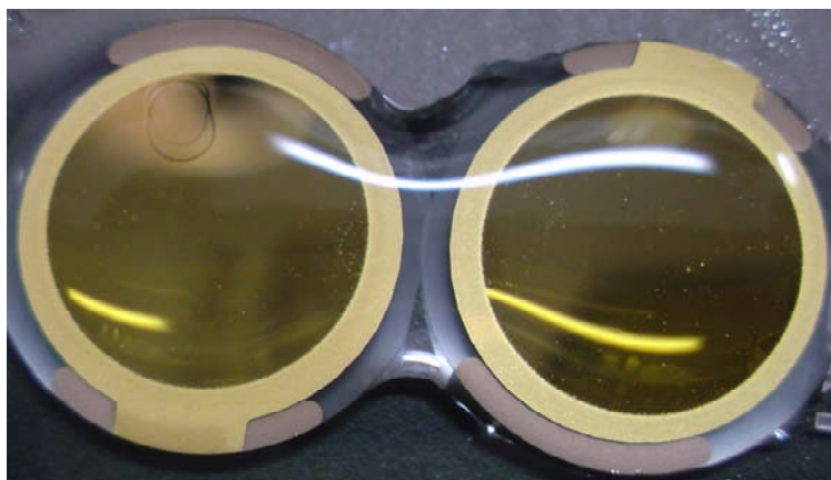
図①-(1A)-2.7 化学重合により AAm ゲルを固定化した Au センサー
