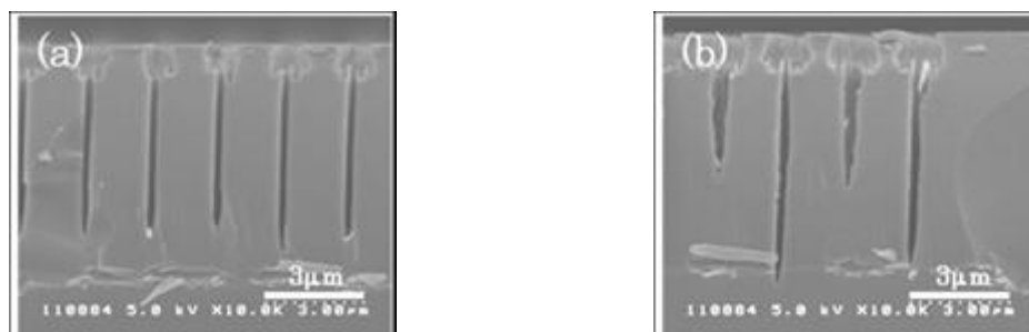
図②-(1)-1.43 トレンチの断面を観察した SEM 像①。(a)レーザパルスエネルギー 50nJ、(b)60nJ にてレーザ照射を行い、その後フッ酸によってエッチングを実施。
