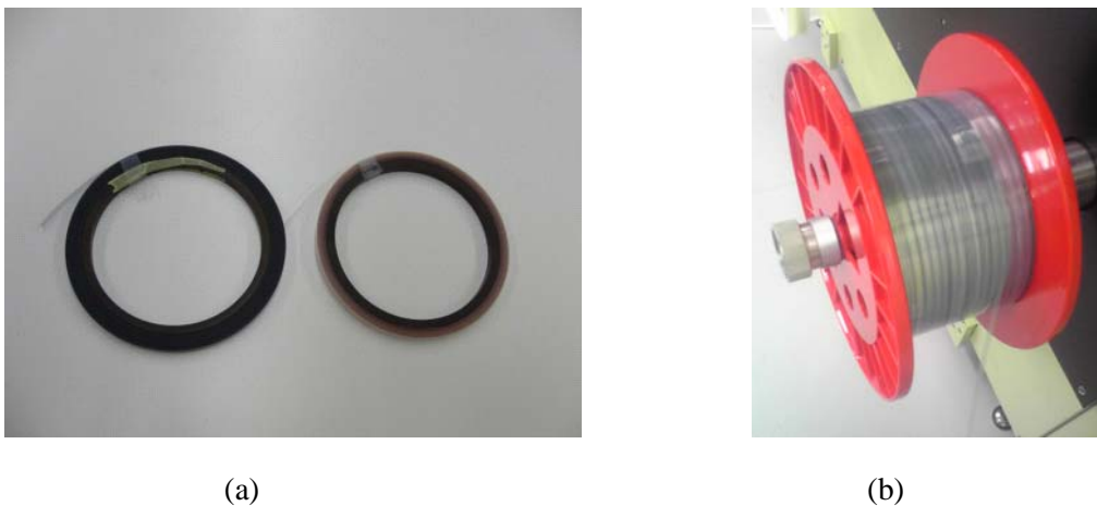
図③-(2)-1.9 試作した長尺被覆基材 (a)プラスチックコア巻き (左: PEDOT 被覆、右: P3HT 被覆)、(b)ボビン巻き
