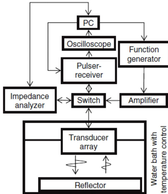
図 2)-1-3-2 素子破壊過程の測定系
