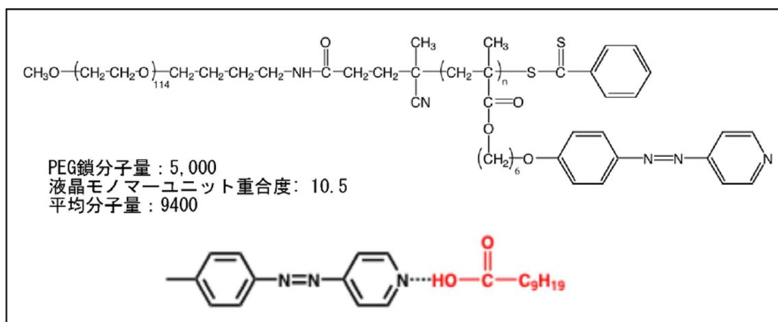
図 2)-3-2-7 液晶性ブロックポリマーの構造式と組成
