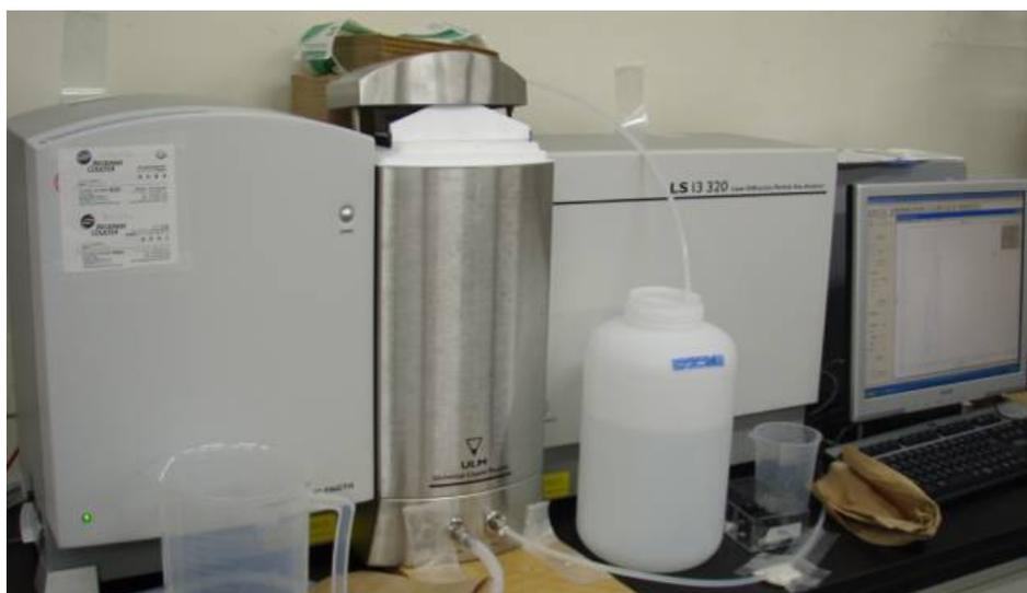
図 2)-1-1-1 レーザー回折光散乱 粒度分布装置 LS 13-320
