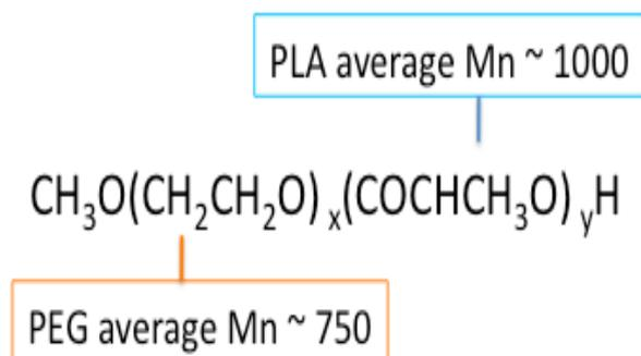
図4 PFP液滴ミセル形成に用いた高分子 PEG-*b*-PLA
