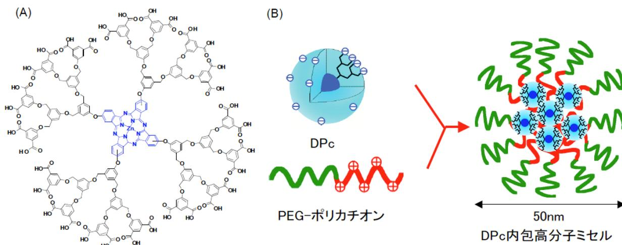
図1-1. (A) デンドリマーフタロシアニン(DPc)の化学構造, (B) DPc内包高分子ミセルの模式図 (1ミセル当たり約77分子のDPcを内包)
