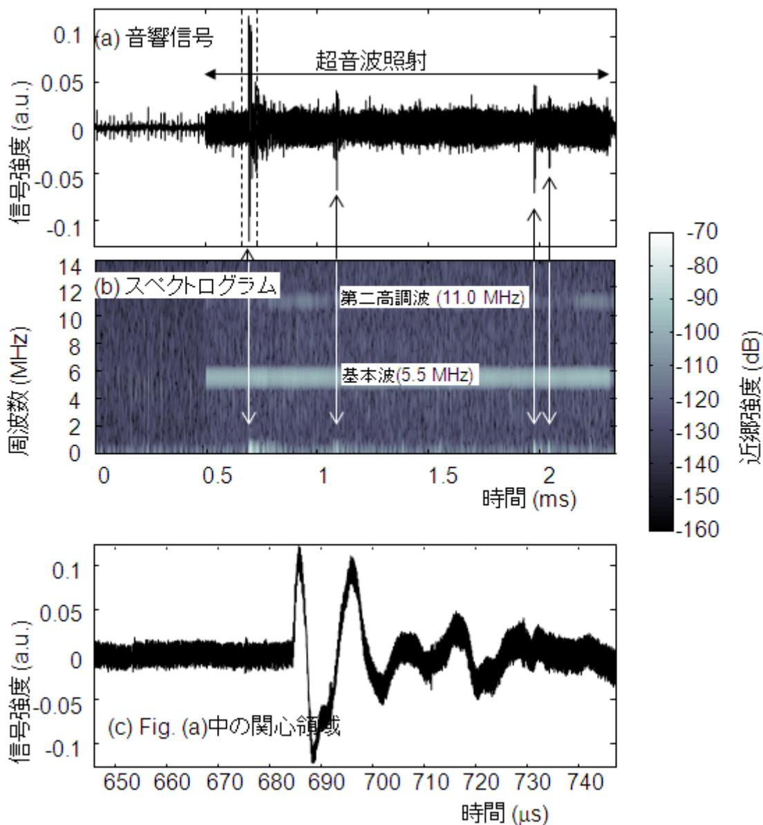
図 2)-2-1-8 相変化時の音響信号(5.5 MHz)
