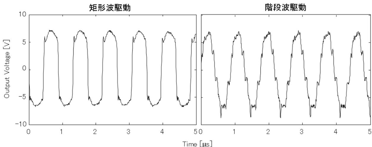
図 2)-2-2-29 単素子球面トランスデューサを試作回路により駆動した電圧波形の例
