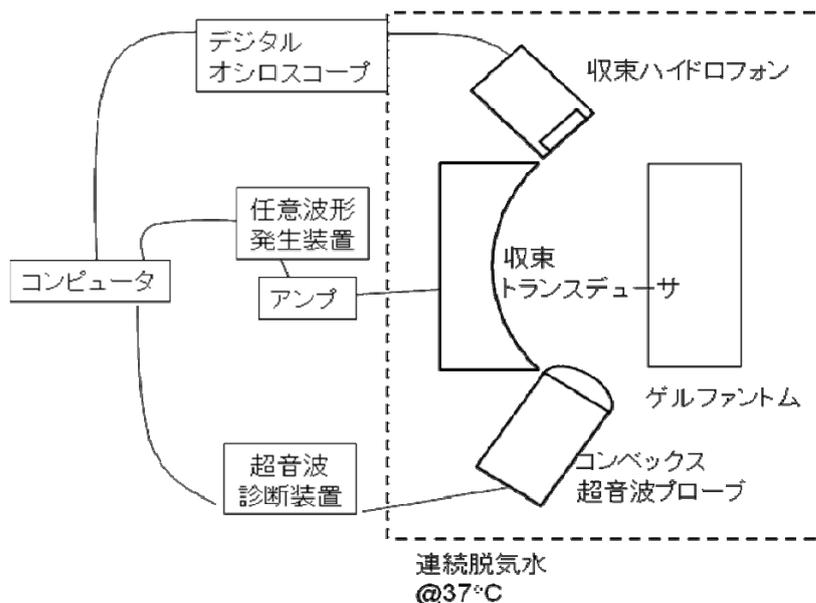
図 2)-2-1-9 超音波照射実験系
