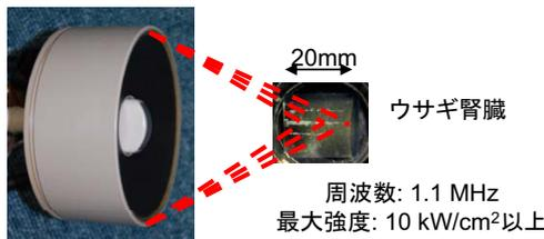
電子可変焦点機構により、治療に十分な強度を保ちつつ±10mmの焦点移動を実現
