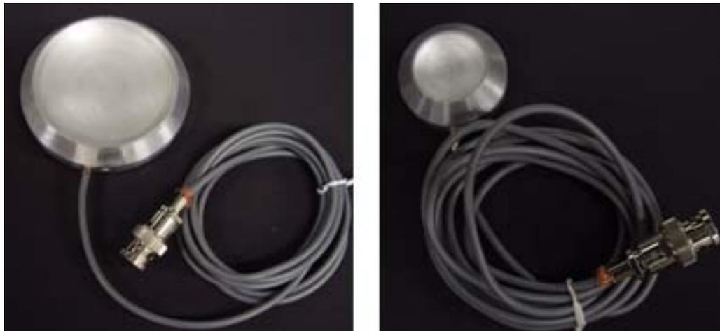
図 2)-2-2-2 開発した単素子球面トランスデューサの例 (左 : 0.8MHz 右 : 8MHz)
