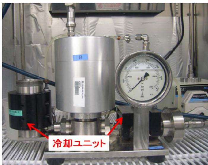
図 2)-1-1-13 高圧乳化処理装置用冷却ユニット
