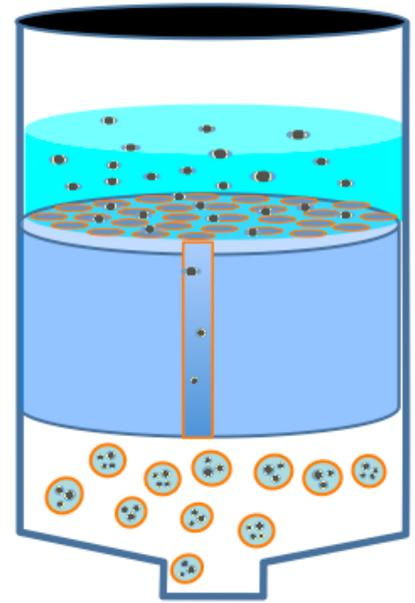
図6 ガラスフィルターHydration法によるPFP液滴ミセルのリポソーム内封化
