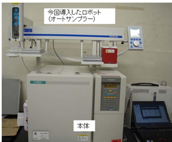
図 2)-1-1-17 オートサンプラーとガスクロマトグラフ装置
