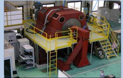
実機運転条件(定格回転数、荷重、給油量、給油温度、ターニング回転数、昇降速レート)を模擬した連続運転試験を実施するための試験装置 軸受径 355mm
