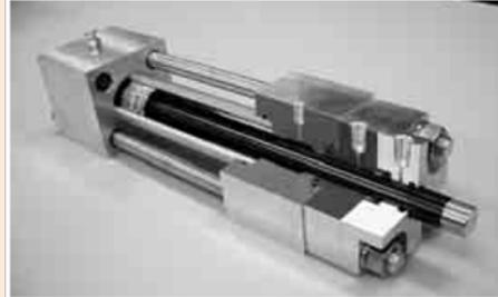
開発DLCを適用した水圧シリンダのカットモデルDLC適用部は中心のシリンダロッド部（写真はナブテスコ㈱のご厚意による）
