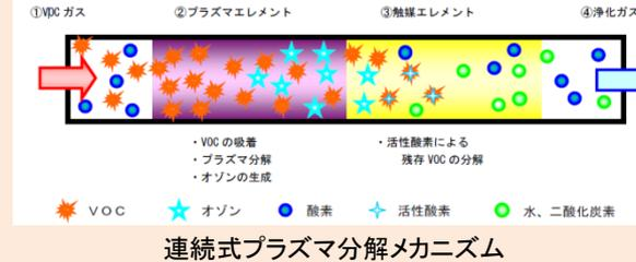
吸着ハニカムを内蔵する**吸着プラズマ分解素子**で、VOCを**プラズマ分解**と**触媒元素**により分解する技術
