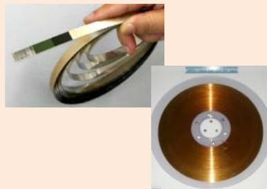
イットリウム系超電導線、500m長超電導線
