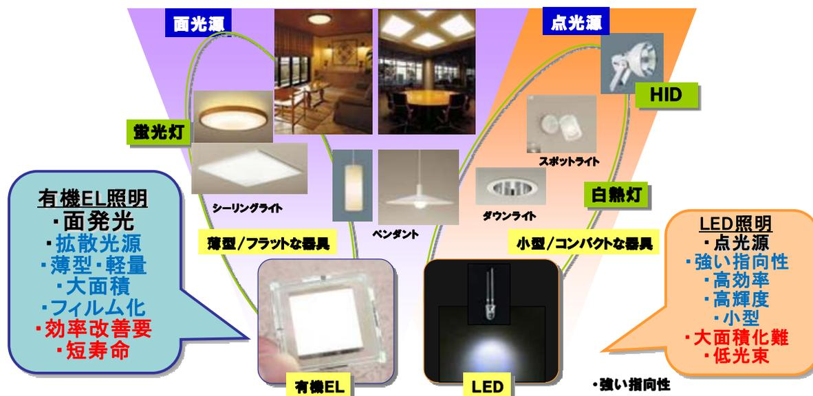
図 2.1.1 有機EL照明とLED照明のすみ分け
