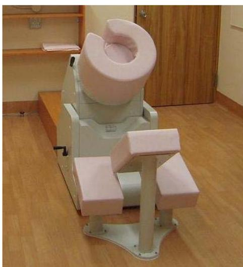
図 2-1-9 座位型マンモ用 PET(C型)2次試作機
