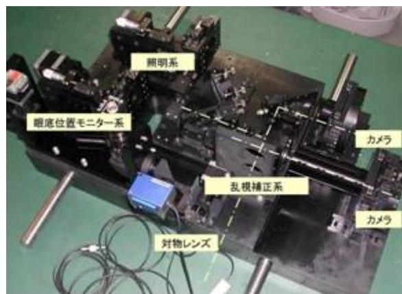
図 2.1.10 プロトタイプ機本体部の光学系
