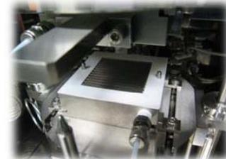
温度・湿度・締結圧を制御できる測定室を備えた計測装置を開発
