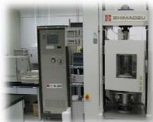
高温水蒸気透過挙動計測装置
