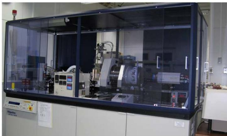
図 2.2-14 小角エックス線散乱測定装置
