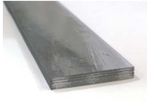
図 3 : メサ型るつぼにより成長した 17 本のリボンの束(幅 56mm)
