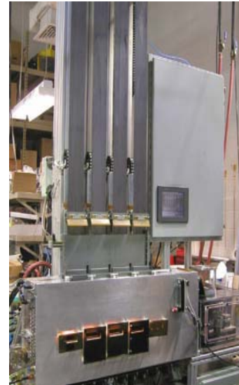
図 5：メサ型るつぼから 4 本のリボンが成長する引き上げ炉
