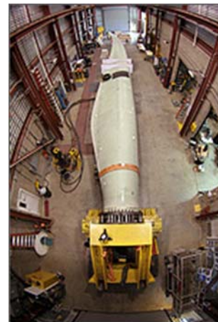
DOE 風力プログラムとともに Knight&Carver 社が開発した STAR の風力タービンブレードが、耐久性や性能をテストする装置に取り付けられている。
