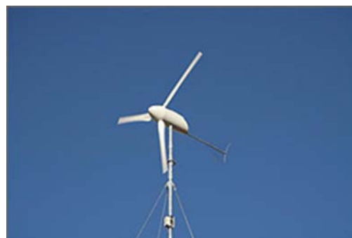
Windward Engineering 社の 4.2kW の 風力タービン
