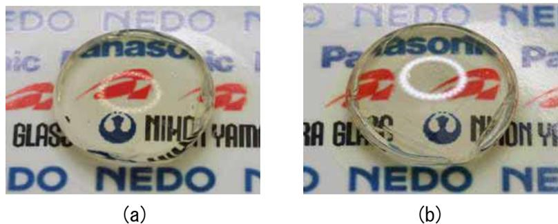
図Ⅲ-24  $ZnO-Bi_2O_3-P_2O_5$  系ガラスの成型品の外観写真 (a) 反射防止構造有り、(b) 無し
