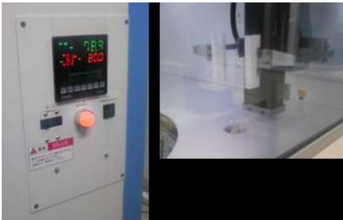
図 2-6 予備凍結制御盤／予備凍結槽
