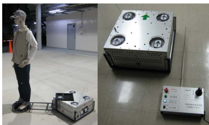
図Ⅲ2.1.2-49 障害物接近再現装置(右)、対象障害物(大人)を取り付けた装置(左)
