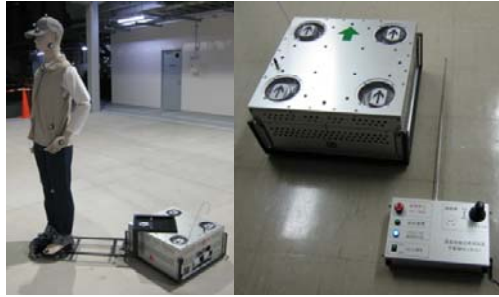
図Ⅲ2.1.2-30 障害物接近再現装置(右)、対象障害物(大人)を取り付けた装置(左)
