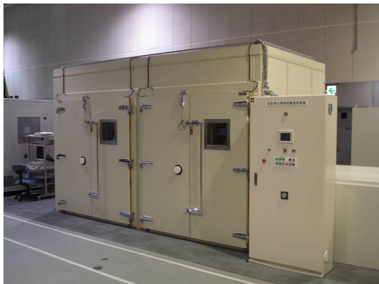
図Ⅲ.2.1.2-8 複合環境試験装置外観
