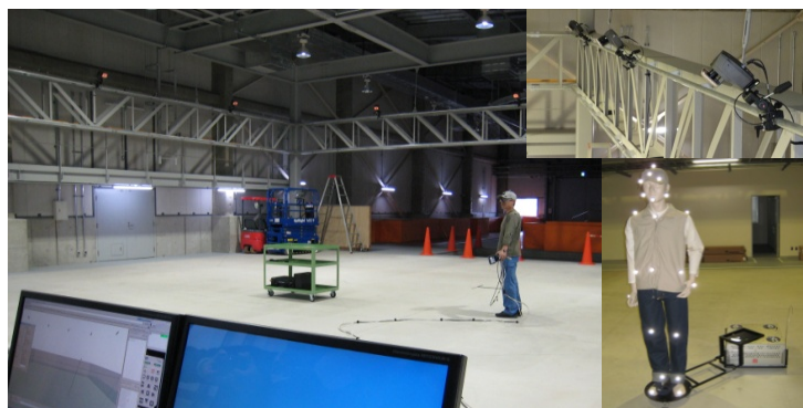
図Ⅲ2.1.2-48 三次元動作解析装置カメラ(右上)、マークを取り付けた対象障害物(右下)、試験エリアと計測の様子(左)
