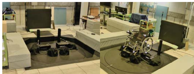
図Ⅲ2.1.2-31 ロボット走行状態模擬装置(左)、電動車いすを搭載した状態(右)
