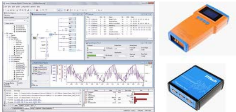
図Ⅲ2.1.2-52 通信障害挿入試験装置
