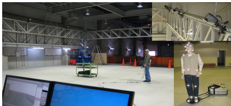
図Ⅲ2.1.2-29 三次元動作解析装置カメラ(右上)、マーカを取り付けた対象障害物(右下)、試験エリアと計測の様子(左)
