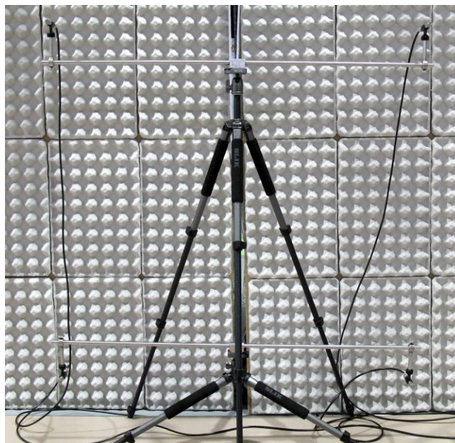
図Ⅲ.2.1.2-14 通過騒音測定用 4 マイクロホンの設置状況 (1m 四方の頂点に配置、後方は吸音材)
