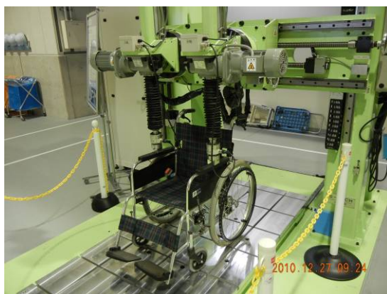
(a) 耐荷重試験
