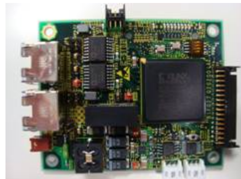
図III.2.4-16 TTP/C バスインターフェースカード (末端接続機器用 65[mm]×80[mm])
