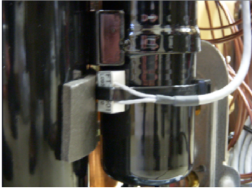
図 4.2.3 圧縮機回転数を計測するための回転計ピックアップ (左図：A 社圧縮機に設置した漏洩磁束検出器 右図：C 社圧縮機に設置した加速度検出器)
