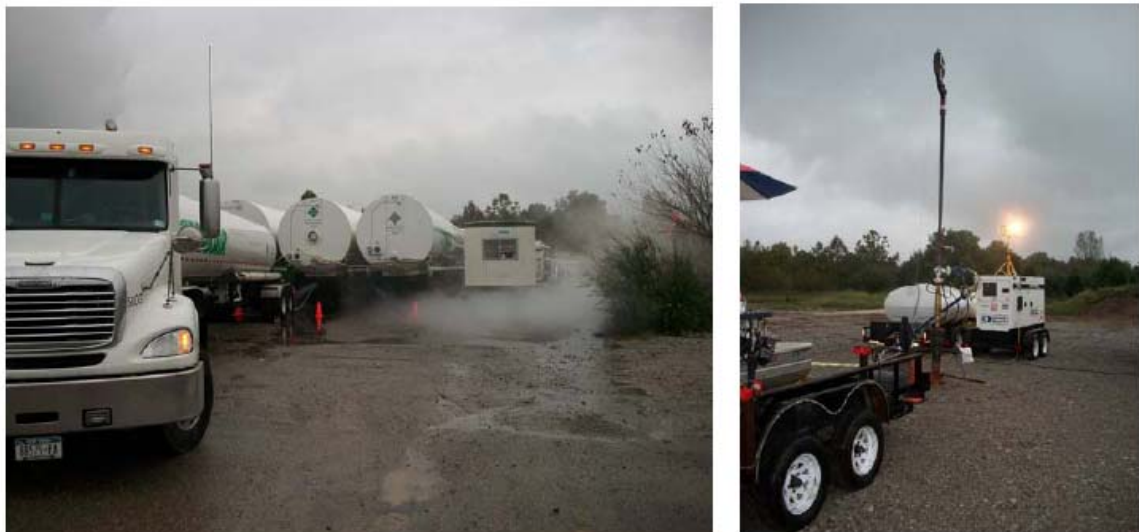
図 1: 左: CO 2 が暫定的にサイトで貯留タンクに保管される。本テストに使用された CO 2 は、食品産業で通常使用されるものと同じ組成を持つ。CO 2 は標準的な配送用トラックによって液状で輸送される。右: 圧入目標(Mt. Simon Sandstone 層)は、地下半マイルを上回る深さにある。圧入井は中央に示される。
