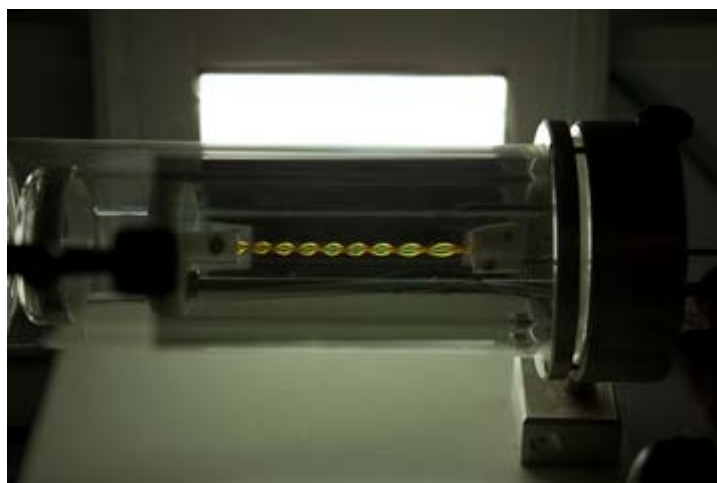
© CNRS Photothèque / ESPCI / Cyril FRÉSILLON オーブンの中で材料の一片が変形されている。ねじりストレス試験中の新素材は、偏光下の鮮やかな色で輝いて見える。これらの色は加熱されると数分で薄れていく：そして材料は新しく形状記憶される。
