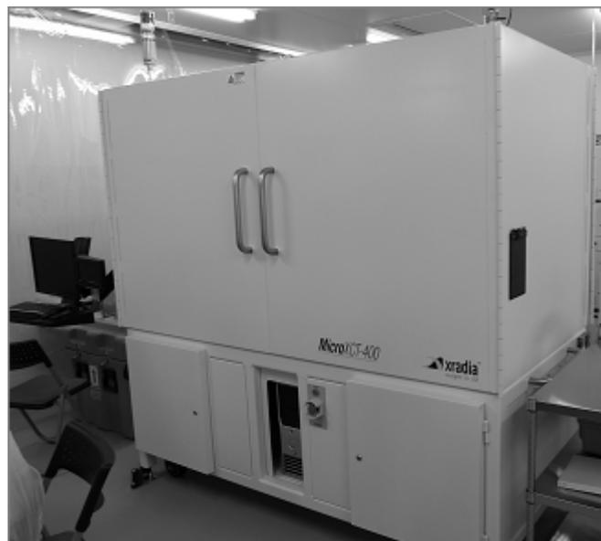
図V.2.5.2-3 MicroXCT-400 外観
