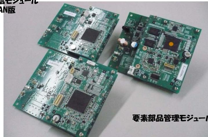
基盤通信モジュール PLC-Zigbee版
