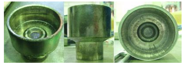
試作鍛造品外観 (鍛造温度300°C)
