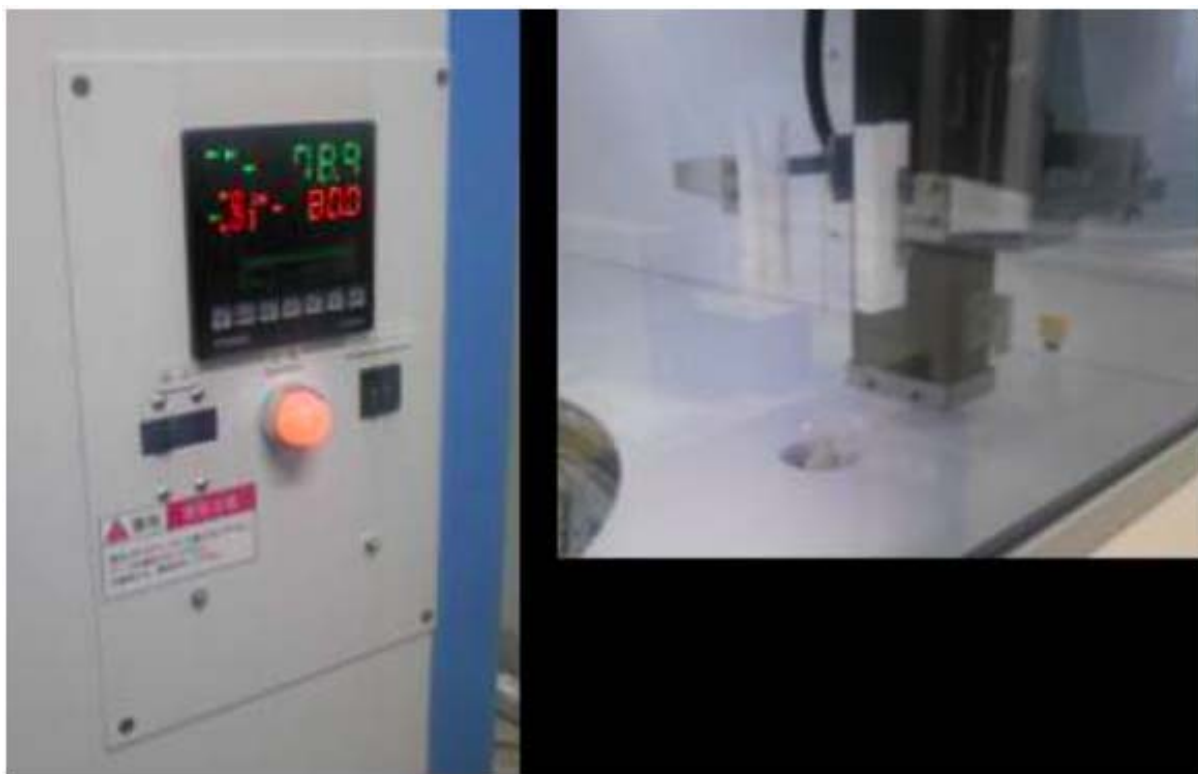
図 2-6 予備凍結制御盤／予備凍結槽
