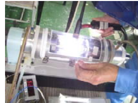
図 丸棒突合せ溶接継手TIG溶接(アルゴンガス雰囲気中)
