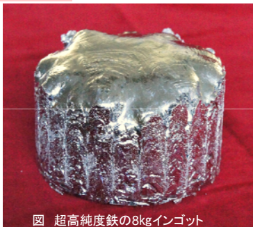
図 超高純度鉄の8kgインゴット
