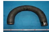
図 試作したシームレスチューブ(高周波曲げ後の外観)
