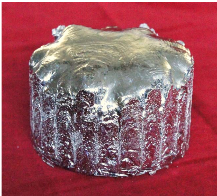
図 19 超高真空コールドクルーシブル溶解して作製した超高純度鉄インゴット
