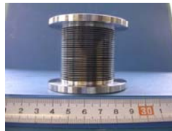
(b)極薄圧延板材(厚さ0.2mm) (c)レーザ溶接組立て後 図 ペローズ(Fe-25Cr-3Al)
