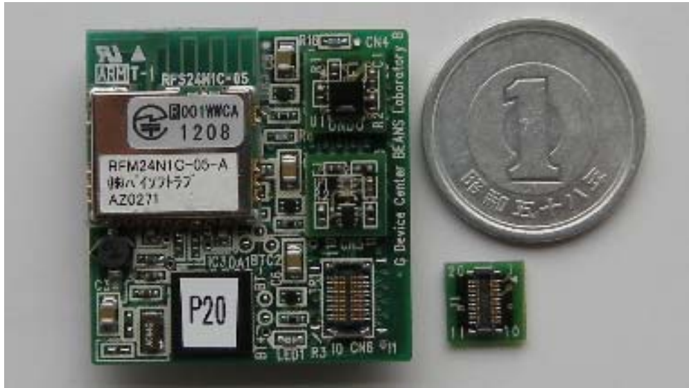
図 V.1.4.1.7 主基板とセンサ子基板裏面
