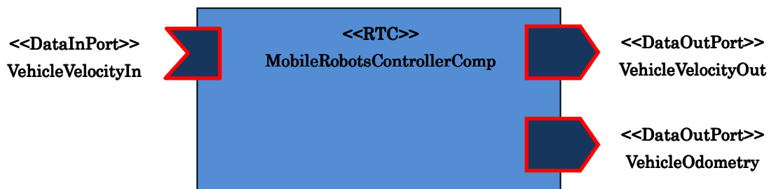
図 3-33 MobileRobotsControllerComp のコンポーネント構成
