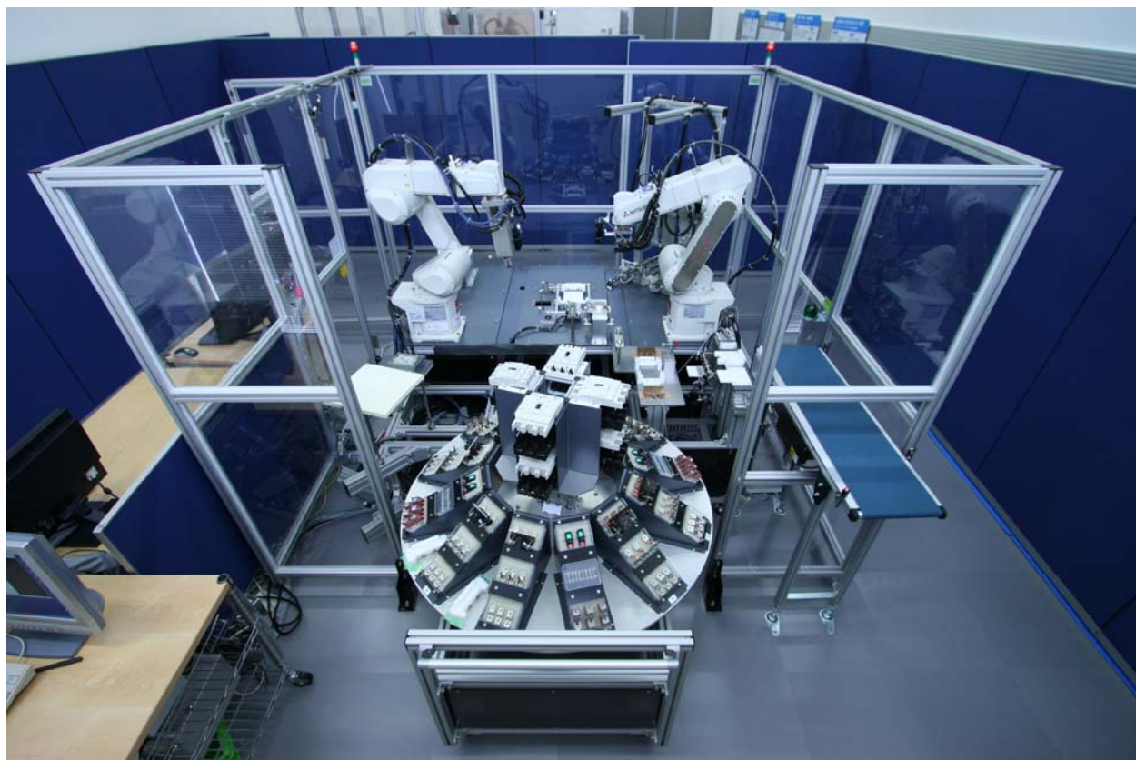
図 2.2.1 統合システムその 2 小型電気電子製品の組立システム
