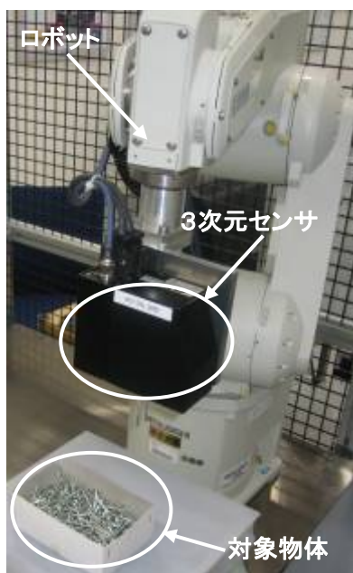
図 3.4.1.1 部品ピッキング用物体認識モジュールの実行の様子
