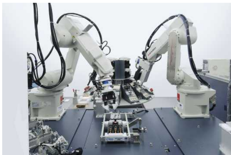
図 2.2.2 統合システムその 2 における組立作業の様子
