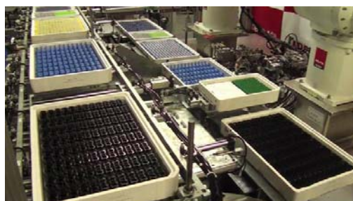
図 14 部品供給モジュールによる部品トレイの交換
