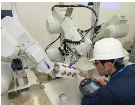
図 3.2.1.1 産業用ロボットの教示作業：ティーチングペンダントで位置・姿勢を調整
