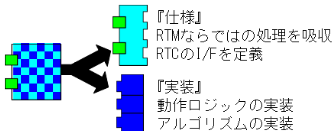
図 5 2層化 RTC の構造
