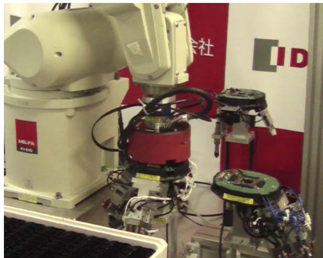
図 60 ツールチェンジのロボット動作
