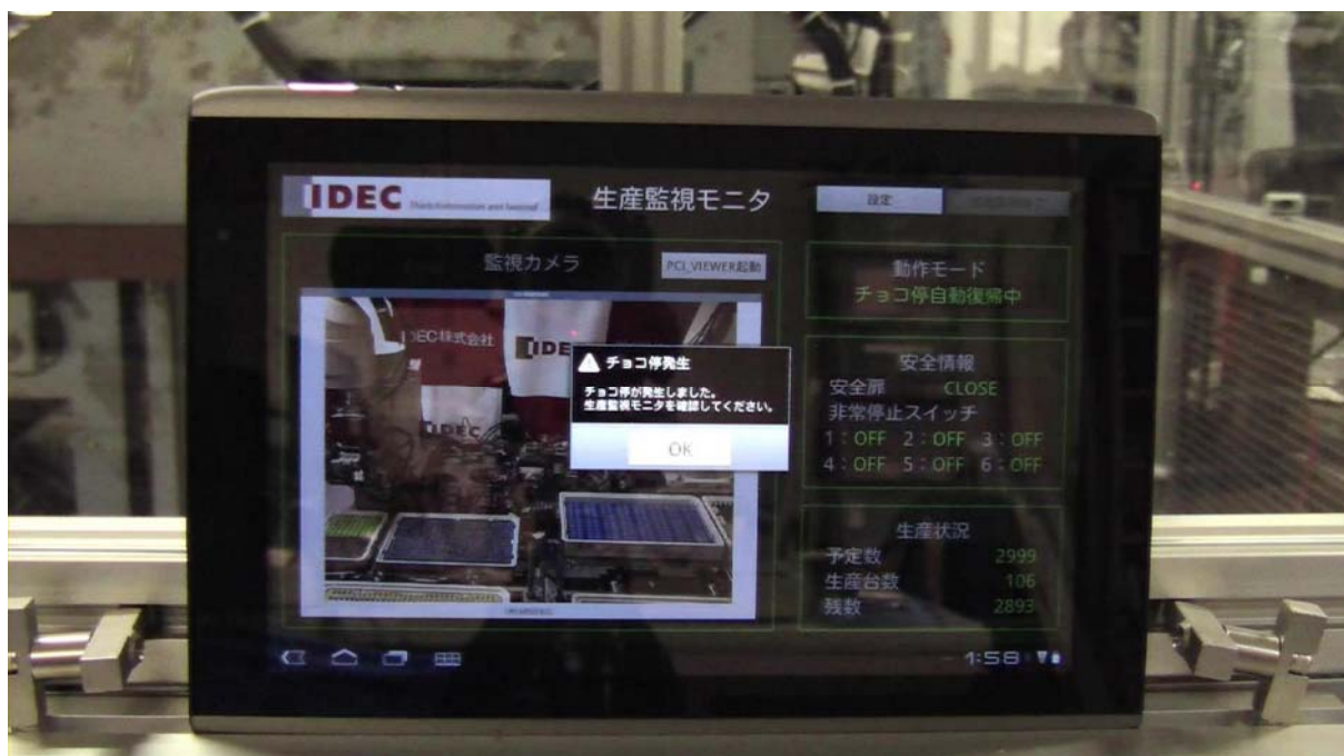
図 61 Android タブレットの簡易モニタ RT コンポーネントの画面
