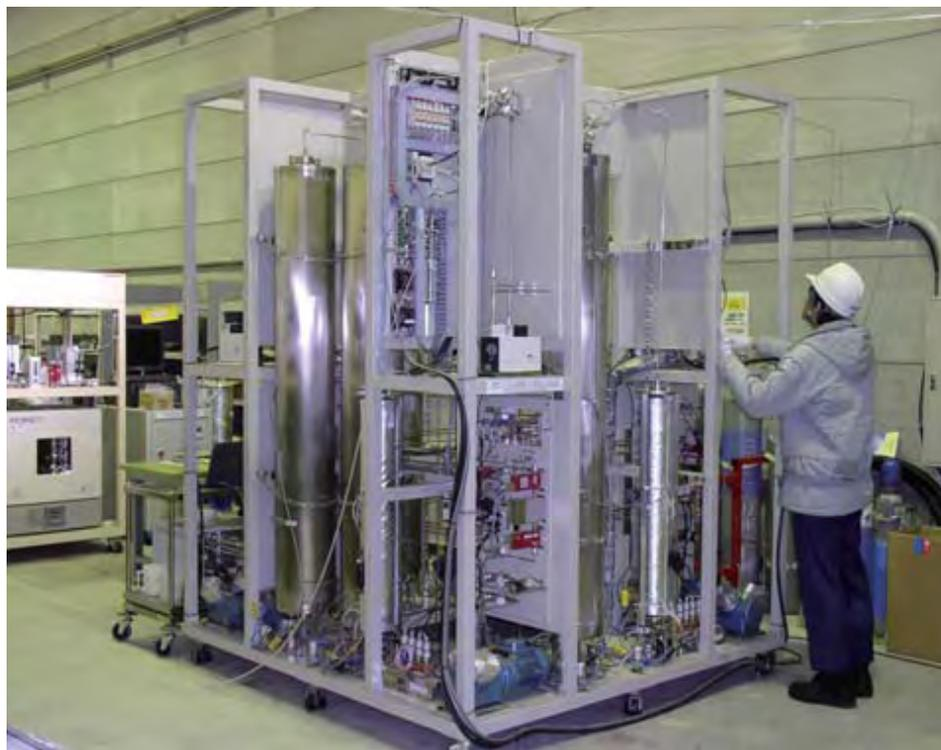
▲ 助成事業で製作した大型連続ガスクロマトグラフィ実証装置
