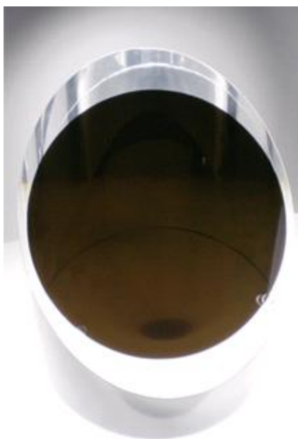
図 III. 2.1.1.1-9 口径 6 インチウエハ外観
