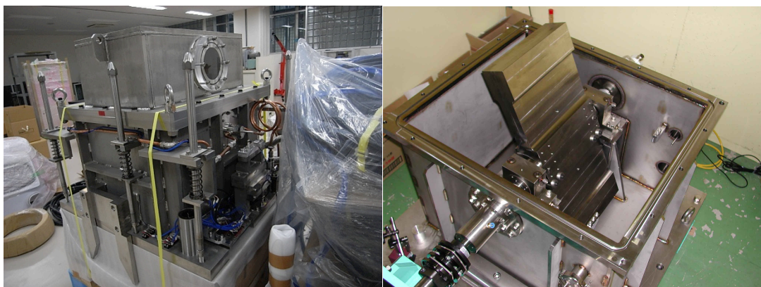
図Ⅲ.2.5.-(10) T0 チョッパーの内部。インコネル製のローターは真空中で回転する。
