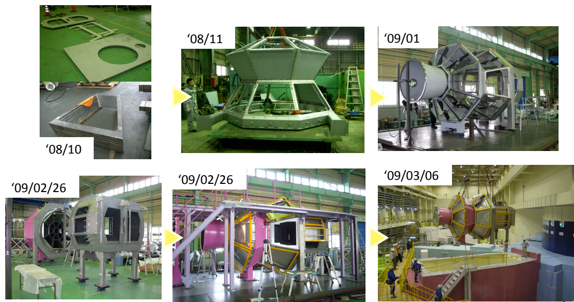
図Ⅲ.2.5.-(15) 全散乱装置真空槽の製作。J-PARC への設置は、平成 21 年 3 月に行われた。
