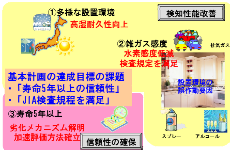
図Ⅲ-2.3.2.1-6 超低消費電力高信頼性ガスセンサー開発への課題
