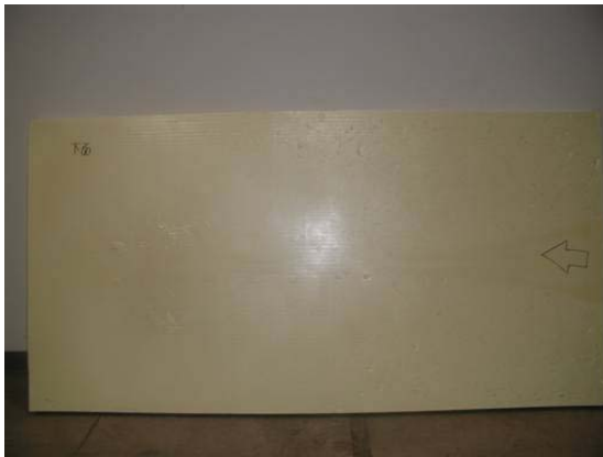
図 3.2.1.3.2.6 PUF パネル 900×1800×50mm
