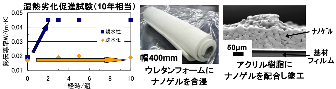
図 3.1.1.3(5) 開発目標の達成度 (複合断熱材技術開発: アキレス株式会社)
