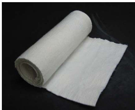
図3.2.1.4.2.6 製造したナノ多孔質シリカ担持断熱材
