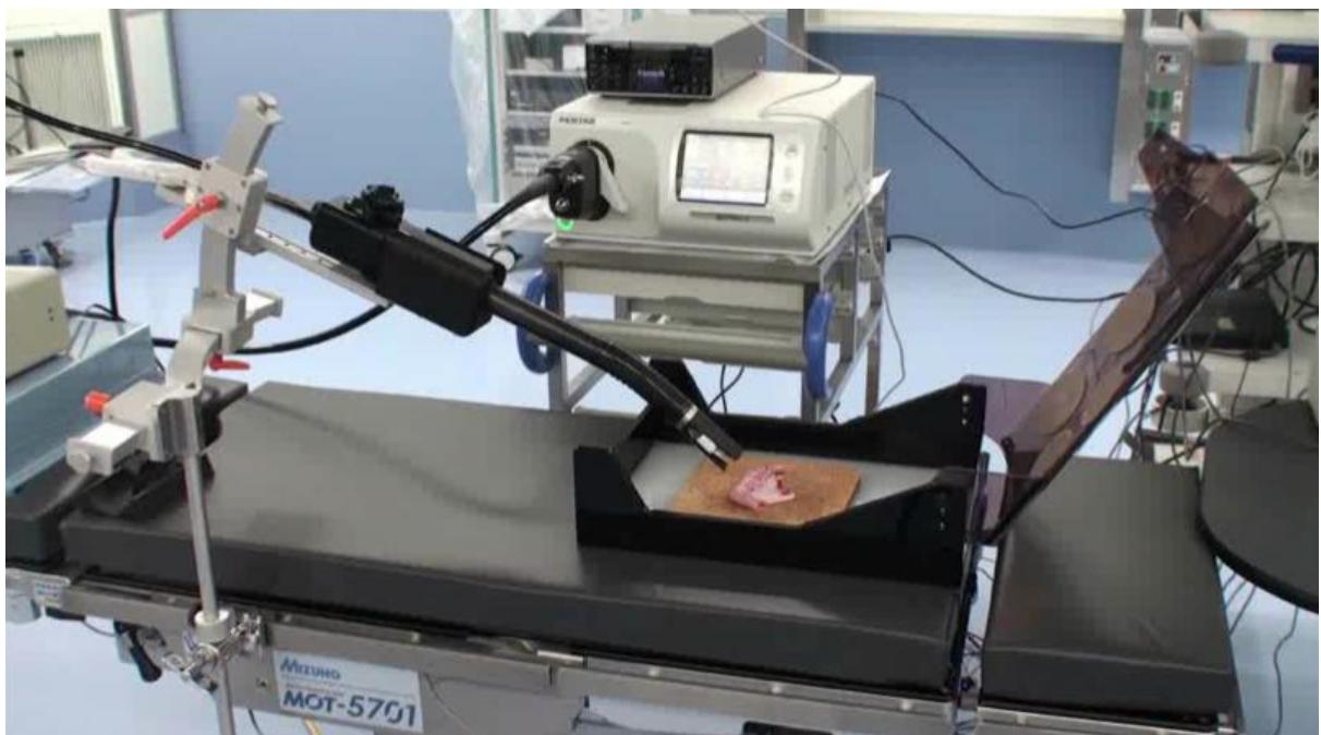
図3 軟性单孔式(SPS)手術支援装置の外観
