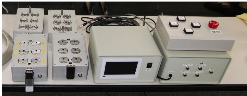
5. **共通コンソール** … 脳神経外科サブプロと消化器外科サブプロにて共同で開発を行なった。用手的手段における手の動き、ツールの種類、ツールの持ち方が大きく異なるため、最終開発物は大きく異なる構成をとるが、通信プロトコルは両者共通であり、基本的な互換性がある(スレーブ側の可動域が異なる、ボタンに割り付けた動作が異なるなど差異があるため完全互換ではない)。その元となつたのは、胸部外科サブプロで試作したハプティックデバイス利用の簡易コンソールである。
