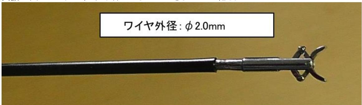
2. FBG 技術 … 脳神経外科サブプロジェクトにて FBG 技術による鉗子の多点力計測の技術を開発して、胸部外科サブプロジェクトに提供した。
