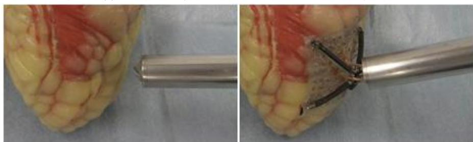
図 9 折りたたみ型多チャネル電極の開閉
