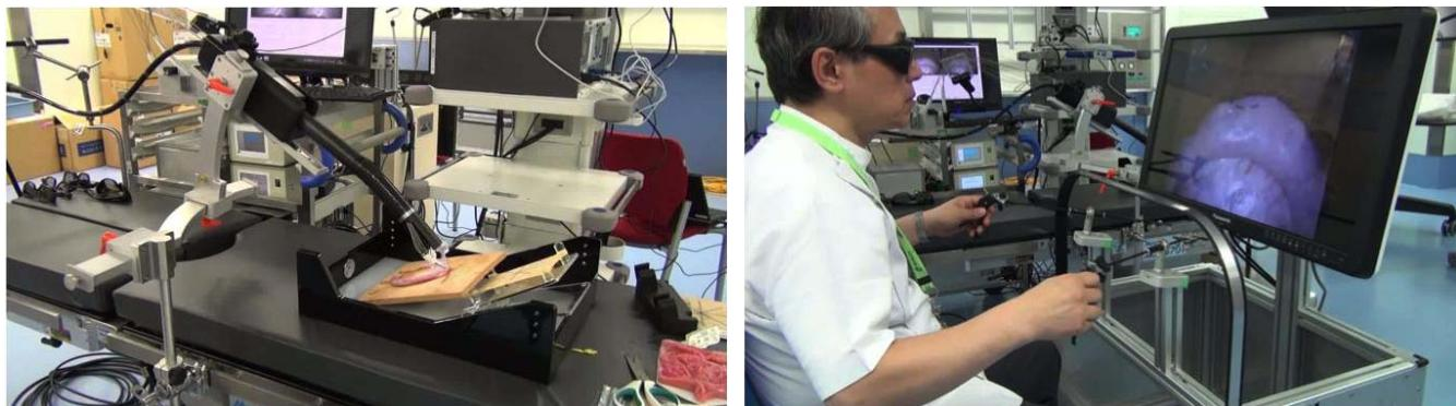
以下の機能・デバイスを統合した軟性单孔式 (SPS:Single Port Surgery) 手術支援装置を開発し、実用化を目指す。
