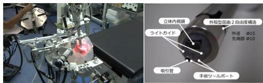
図 10 手術ロボット機構
