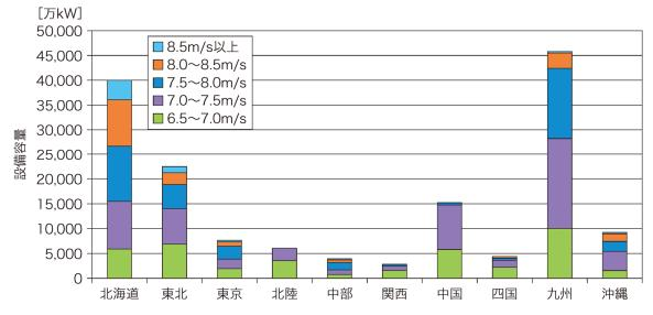
図 3-24 洋上風力の電力供給エリア別の導入ポテンシャル分布状況
