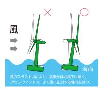
図 3-53 浮体式洋上風車でのダウンウィンド方式の優位性
