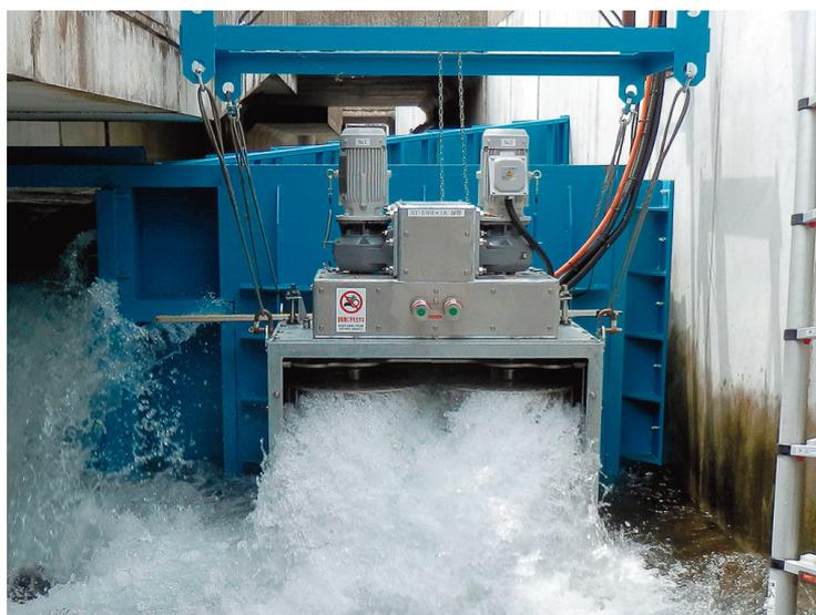
図 8-23 シーベルインターナショナルの小水力発電装置の設置例
