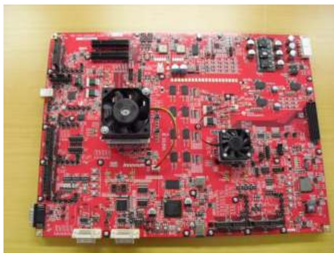
図 3-12 SMYLEvideo の実装検証ボード (東京エレクトロデバイス ASIC 開発評価プラットフォーム TB-7V-2000T-LSI)
